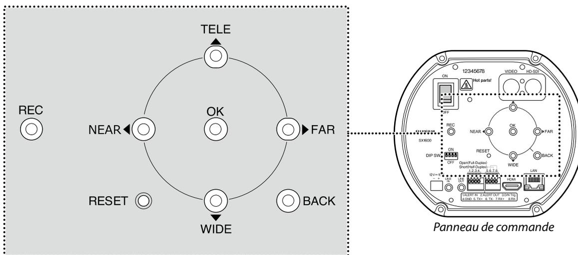
Les boutons suivants permettent de naviguer dans les menus et de commander la caméra :
