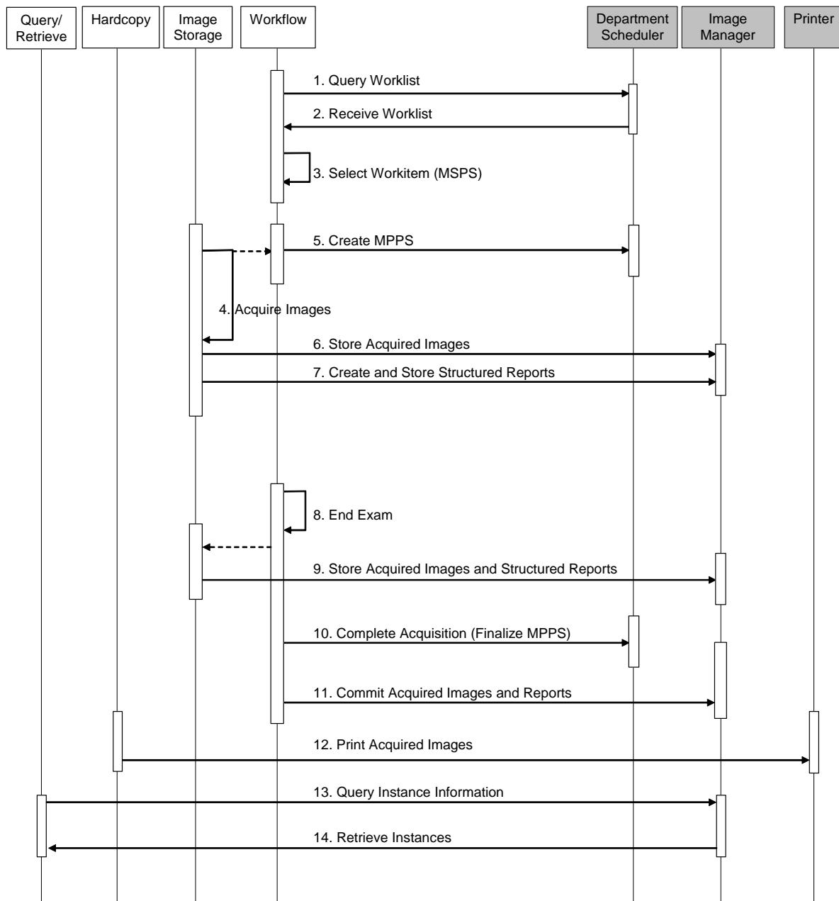
**Figure 4.1-2 SEQUENCING CONSTRAINTS**
