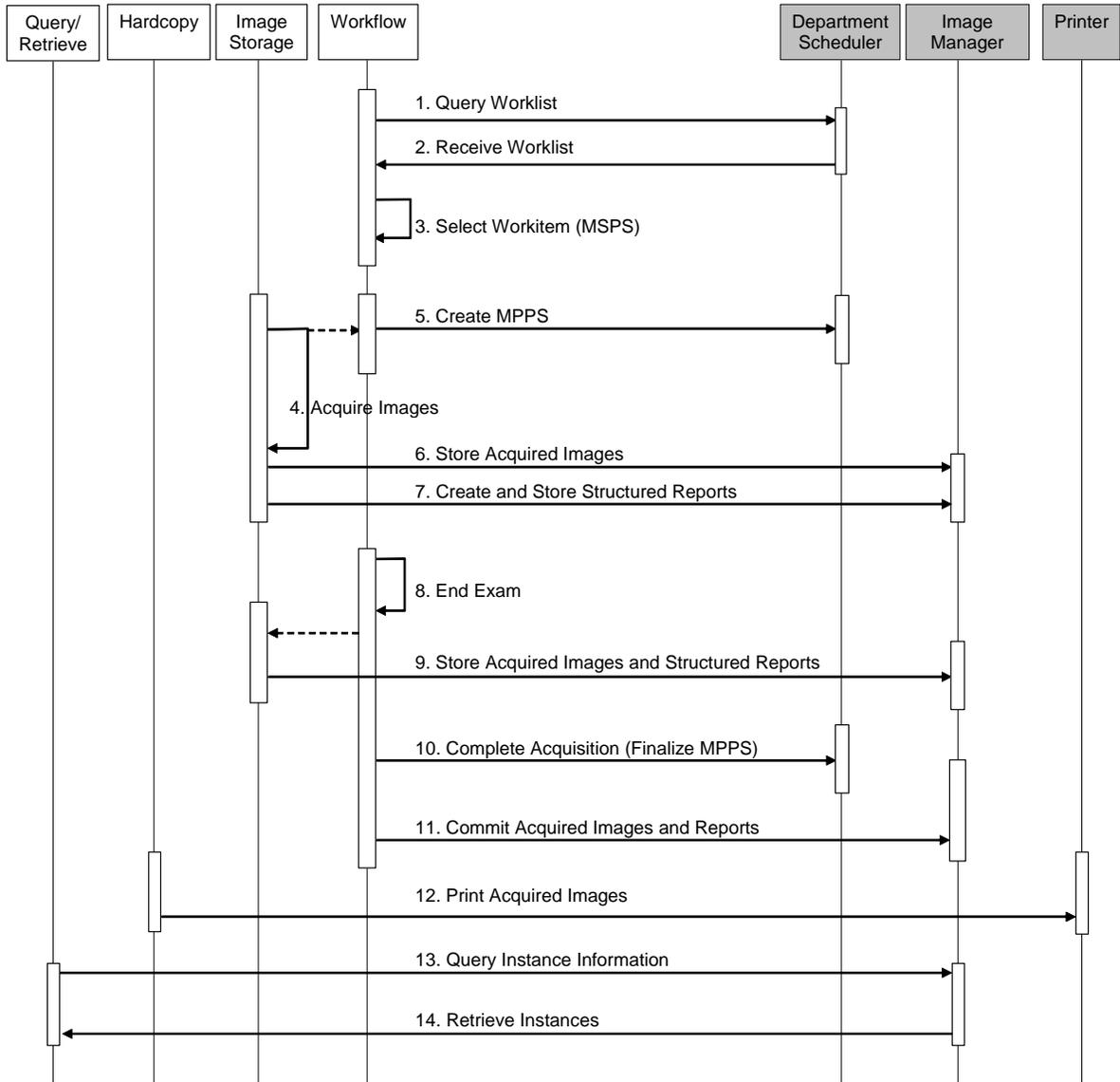
**Figure 4.1-2 SEQUENCING CONSTRAINTS**
