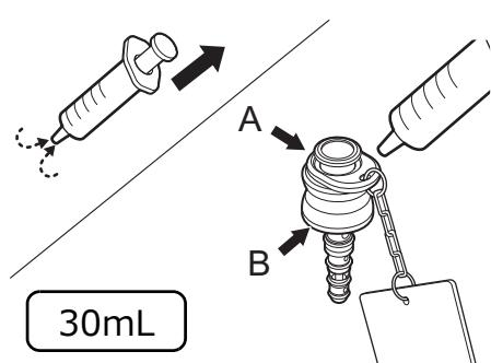
滅菌済みシリンジに空気を入れて、送気送水チャンネル洗浄アダプターの各部に空気を注入します。
