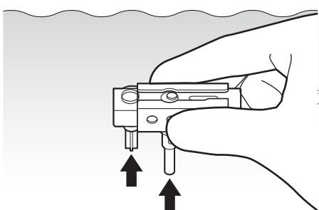
消毒液中で、プラグフレームの送気送水プラグおよび吸引プラグを押し、プラグフレームから気泡が出ないことを確認します。
