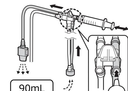
注入チューブの送気送水チャンネル側コネクターに清潔なシリンジを取り付け、空気を吸引し、空気を少なくとも 90mL 注入します。
