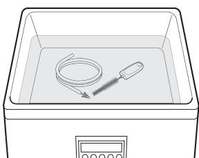
汚れが落ちにくい場合は、洗浄液を満たした超音波洗浄器に、シリンダー用洗浄ブラシおよび吸引チャンネル用洗浄ブラシを完全に浸漬し、下表に示した周波数および時間で超音波洗浄を行うこともできます。
