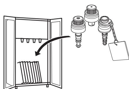
消毒済みの乾燥した吸引ボタン、送気送水ボタンおよび送気送水チャンネル洗浄アダプターを保管します。
