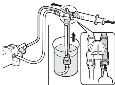
清潔なシリンジで送気送水チャンネル側コネクターに、清浄水を詰まりが除去できるまで注入します。
