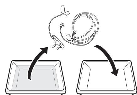
清浄水から、注入チューブおよび管路プラグを取り出し、清潔で大きな容器に入れます。
