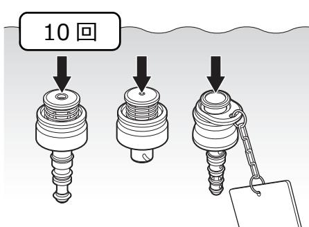
アルコール中で、吸引ボタン、送気送水ボタンおよび送気送水チャンネル洗浄アダプターのボタンを少なくとも 10 回押します。
