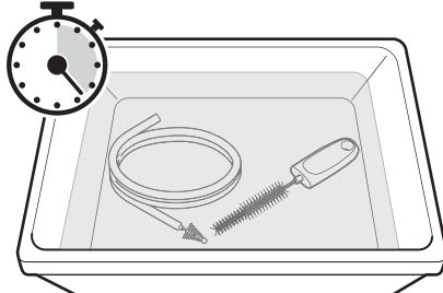
洗浄液製造業者が推奨する温度、濃度、時間に従って、シリンダー用洗浄ブラシおよび吸引チャンネル用洗浄ブラシを完全に浸漬したままにします。
