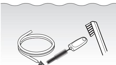
洗浄液中で、シリンダー用洗浄ブラシおよび吸引チャンネル用洗浄ブラシ全体を、清潔な歯ブラシでブラッシングします。
