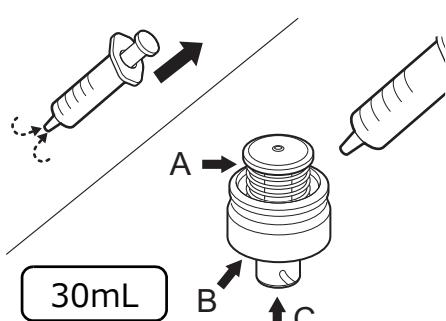
滅菌済みシリンジに空気を入れて、吸引ボタンの各部に空気を注入します。
