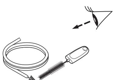
シリンドー用洗浄ブラシおよび吸引チャンネル用洗浄ブラシが乾燥していることを確認します。
