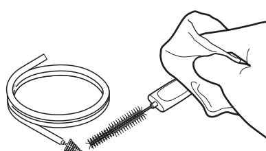
シリンドー用洗浄ブラシおよび吸引チャンネル用洗浄ブラシに残った滅菌水を滅菌ガーゼで拭き取ります。
