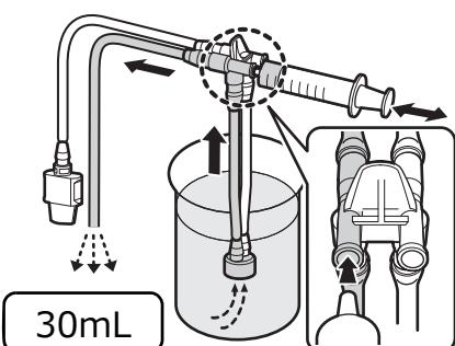
注入チューブの吸引チャンネル側コネクターに滅菌済みシリジを取り付け、アルコールを吸引し、アルコールを少なくとも 30mL 注入します。
