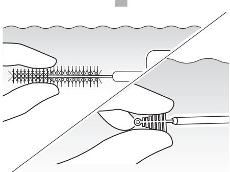
洗浄液中で、シリンダー用洗浄ブラシおよび吸引チャンネル用洗浄ブラシのブラシ部分を少なくとも 10 秒間もみ洗いします。
