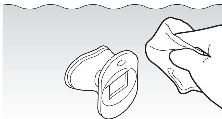
洗浄液中で、マウスピースの外表面を清潔なガーゼで拭きます。
