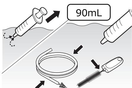
清潔なシリンジに洗浄液を入れて、洗浄液中で、シリンダー用洗浄ブラシおよび吸引チャンネル用洗浄ブラシ全体に、洗浄液を少なくとも 90mL 注入します。
