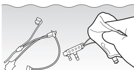
消毒液中で、注入チューブおよび管路プラグの外表面を清潔なガーゼで十分に拭きます。
