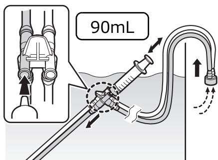
洗浄液中で、注入チューブの吸引チャンネル側コネクターに清潔なシリンジを取り付け、空気を吸引し、空気を少なくとも 90mL 注入します。
