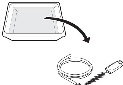
滅菌水から、シリンドー用洗浄ブラシおよび吸引チャンネル用洗浄ブラシを取り出します。
