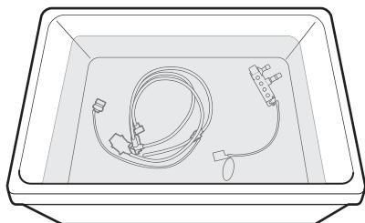
洗浄液製造業者が推奨する温度、濃度、時間に従って、注入チューブおよび管路プラグを完全に浸漬したままにします。
