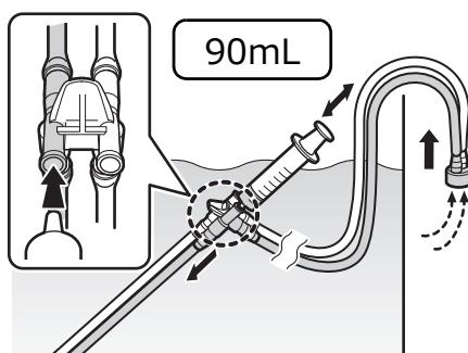
注入チューブの吸引チャンネル側コネクターに滅菌済みシリンジを取り付け、空気を吸引し、空気を少なくとも 90mL 注入します。
