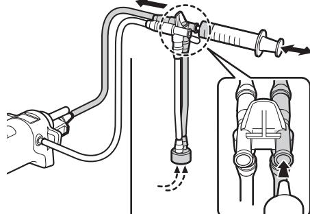
送気送水チャンネル内の水分がすべて排出されるまで、清潔なシリンジで送気送水チャンネル側コネクターに、空気を注入します。
