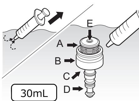
清潔なシリンジに消毒液を入れて、消毒液中で、送気送水ボタンの各部に消毒液を注入して気泡を完全に除去します。
