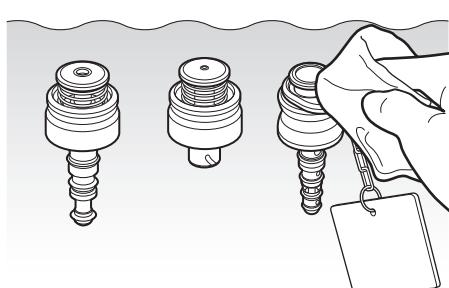
消毒液中で、吸引ボタン、送気送水ボタンおよび送気送水チャンネル洗浄アダプターの外表面を清潔なガーゼで十分に拭きます。
