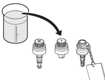
アルコールから、吸引ボタン、送気送水ボタンおよび送気送水チャンネル洗浄アダプターを取り出します。
