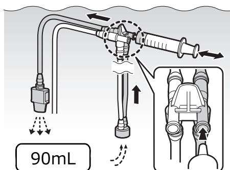
清浄水中で、注入チューブの送気送水チャンネル側コネクターに清潔なシリンジを取り付け、清浄水を吸引し、清浄水を少なくとも 90mL 注入します。
