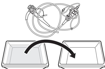
洗浄液から、洗浄アダプターを取り付けたまま内視鏡を取り出し、清潔な容器に入れます。
