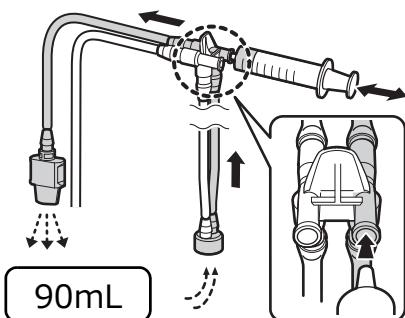
注入チューブの送気送水チャンネル側コネクターに滅菌済みシリンジを取り付け、空気を吸引し、空気を少なくとも 90mL 注入して滅菌水を排出します。
