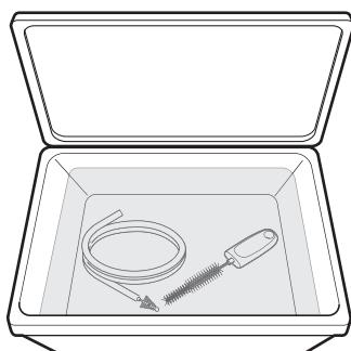
消毒液中に、シリンダー用洗浄ブラシおよび吸引チャンネル用洗浄ブラシを浸漬します。
