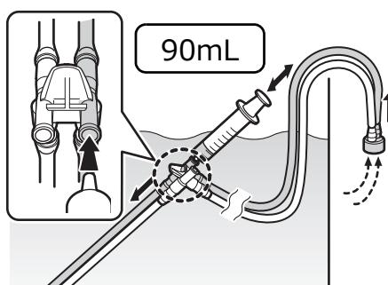
洗浄液中で、注入チューブの送気送水チャンネル側コネクターに清潔なシリンジを取り付け、空気を吸引し、空気を少なくとも 90mL 注入します。
