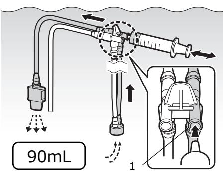
洗浄液中で、注入チューブの送気送水チャンネル側コネクター（右側）に清潔なシリンジを取り付け、洗浄液を吸引し、洗浄液を少なくとも 90mL 注入します。
