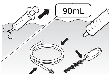
滅菌済みシリンジに消毒液を入れて、消毒液中で、シリンダー用洗浄ブラシおよび吸引チャンネル用洗浄ブラシ全体に、消毒液を少なくとも90mL注入します。
