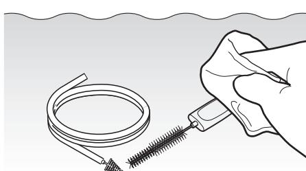
消毒液中で、シリンダー用洗浄ブラシおよび吸引チャンネル用洗浄ブラシの外表面を清潔なガーゼで十分に拭きます。
