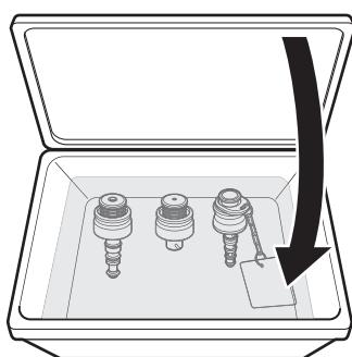
消毒液製造販売業者が推奨する温度、濃度、時間に従って、消毒液中に吸引ボタン、送気送水ボタンおよび送気送水チャンネル洗浄アダプターを完全に浸漬して消毒します。消毒している間は、清潔で大きなフタ付き容器のフタをします。
