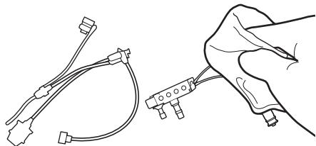
注入チューブおよび管路プラグに残った清浄水を清潔なガーゼで拭き取ります。
