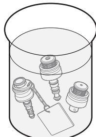
アルコール中に、吸引ボタン、送気送水ボタンおよび送気送水チャンネル洗浄アダプターを浸漬します。
