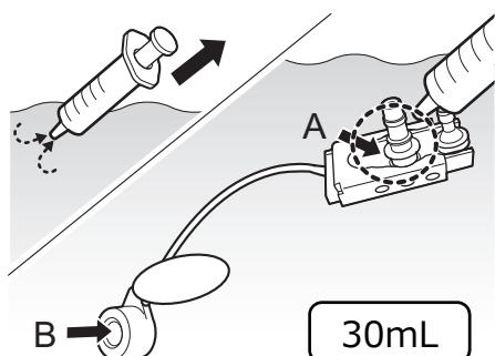
清潔なシリンジに消毒液を入れて、消毒液中で、管路プラグの各部に消毒液を注入して気泡を完全に除去します。
