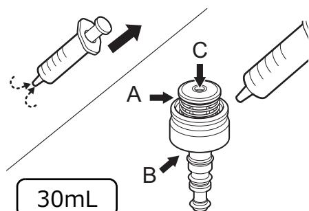
滅菌済みシリンジに空気を入れて、送気送水ボタンの各部に空気を注入します。
