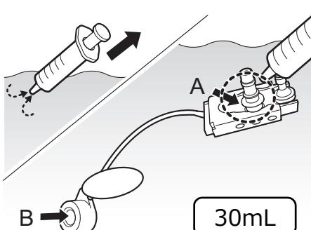
清潔なシリンジに清浄水を入れて、清浄水中で、管路プラグの各部に清浄水を注入します。
