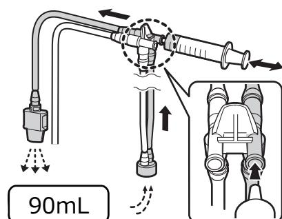
管路プラグの送気送水チャンネル側コネクターに滅菌済みシリンジを取り付け、空気を吸引し、空気を少なくとも 90mL 注入します。
