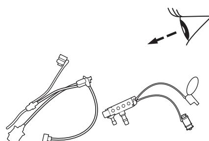
注入チューブおよび管路プラグが乾燥していることを確認します。
