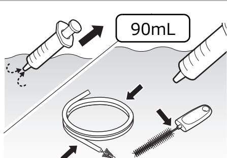
清潔なシリンジに清浄水を入れて、清浄水中で、シリンダー用洗浄ブラシおよび吸引チャンネル用洗浄ブラシ全体に、清浄水を少なくとも 90mL 注入します。
