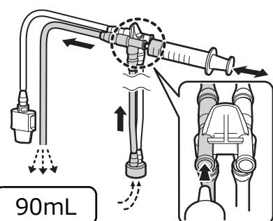
管路プラグの吸引チャンネル側コネクターに滅菌済みシリジを取り付け、空気を吸引し、空気を少なくとも 90mL 注入します。
