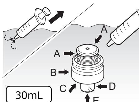
清潔なシリンジに消毒液を入れて、消毒液中で、吸引ボタンの各部に消毒液を注入して気泡を完全に除去します。
