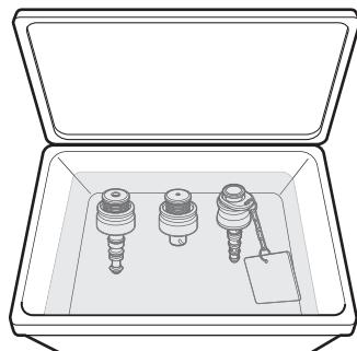
消毒液中に、吸引ボタン、送気送水ボタンおよび送気送水チャンネル洗浄アダプターを浸漬します。
