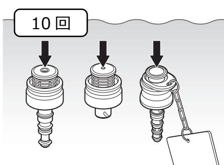
消毒液中で、吸引ボタン、送気送水ボタンおよび送気送水チャンネル洗浄アダプターのボタンを少なくとも 10 回押します。
