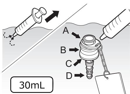
滅菌済みシリンジに滅菌水を入れて、滅菌水中で、送気送水チャンネル洗浄アダプターの各部に滅菌水を注入します。
