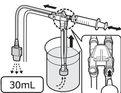
注入チューブの送気送水チャンネル側コネクターに滅菌済みシリジを取り付け、アルコールを吸引し、アルコールを少なくとも 30mL 注入します。
