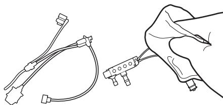
注入チューブおよび管路プラグに残った滅菌水を滅菌ガーゼで拭き取ります。
