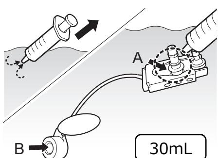
滅菌済みシリンジに滅菌水を入れて、滅菌水中で、管路プラグの各部に滅菌水を注入します。
