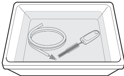
洗浄液中に、シリンダー用洗浄ブラシおよび吸引チャンネル用洗浄ブラシを浸漬します。
