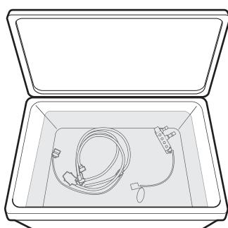
消毒液中に、注入チューブおよび管路プラグを浸漬します。
