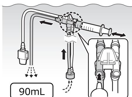
清浄水中で、注入チューブの吸引チャンネル側コネクターに清潔なシリンジを取り付け、清浄水を吸引し、清浄水を少なくとも 90mL 注入します。
