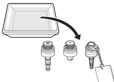
吸引ボタン、送気送水ボタンおよび送気送水チャンネル洗浄アダプターを滅菌水から取り出します。
