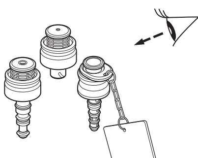
吸引ボタン、送気送水ボタンおよび送気送水チャンネル洗浄アダプターが乾燥していることを確認します。
