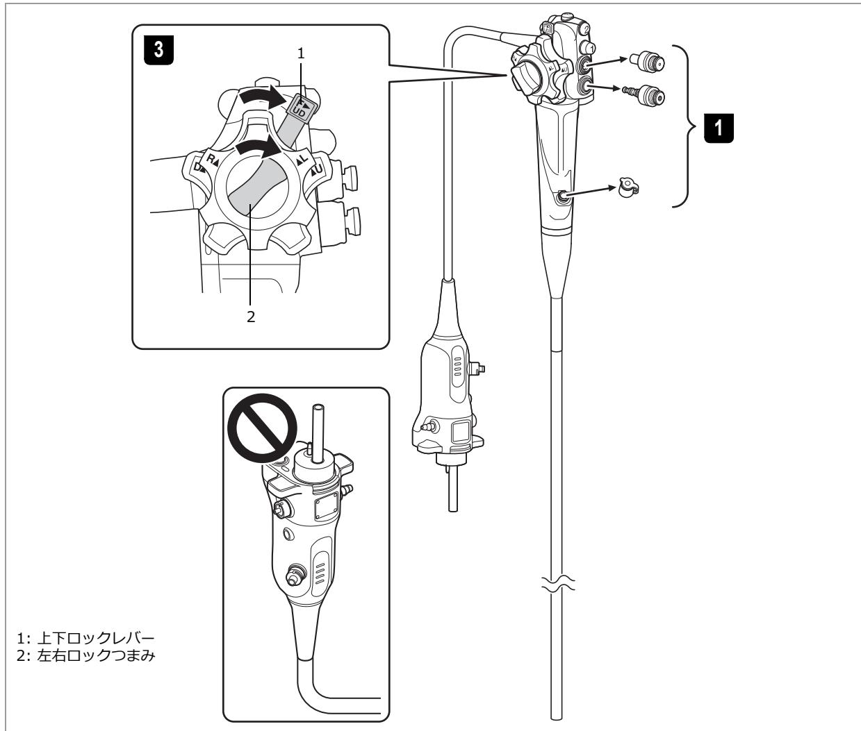
**1** 送気送水ボタン、吸引ボタン、鉗子栓などのすべての付属品が内視鏡から外れていることを確認します。
