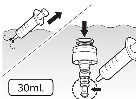
清潔なシリンジに消毒液を入れて、消毒液中で、送気送水ボタンのボタンを完全に押したときに見える軸部分に、消毒液を少なくとも 30mL 注入して気泡を完全に除去します。
