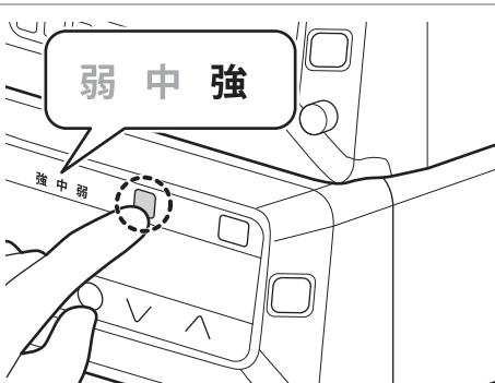
プロセッサーの送気表示灯の表示が「強」になるまで、送気ボタンを押します。
