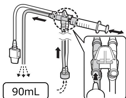
注入チューブの吸引チャンネル側コネクターに滅菌済みシリンジを取り付け、空気を吸引し、空気を少なくとも 90mL 注入して滅菌水を排出します。
