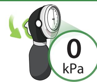
トリガーを解放側に押して空気を排出します。
