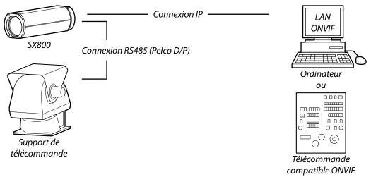
Lorsque la caméra est connectée à un ordinateur via des protocoles Internet (IP), un navigateur Internet permet de modifier ses réglages et une application ONVIF d'afficher l'image en temps réel et de commander la caméra.
