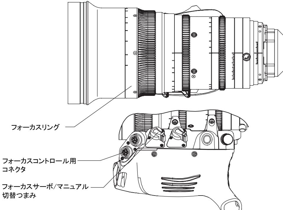
フォーカスリングを直接手で回して、焦点を合わせます。
