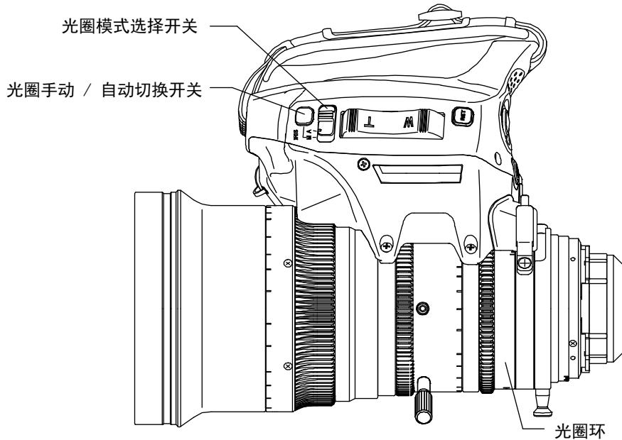
光圈模式有两种：自动光圈和手动光圈。在各种模式中的操作说明请参阅各种模式的相关介绍。
