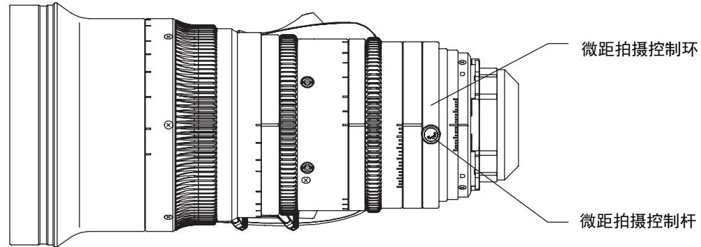
执行以下步骤进行微距拍摄（近处拍摄）。
