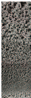
PSE膜の断面SEM写真
