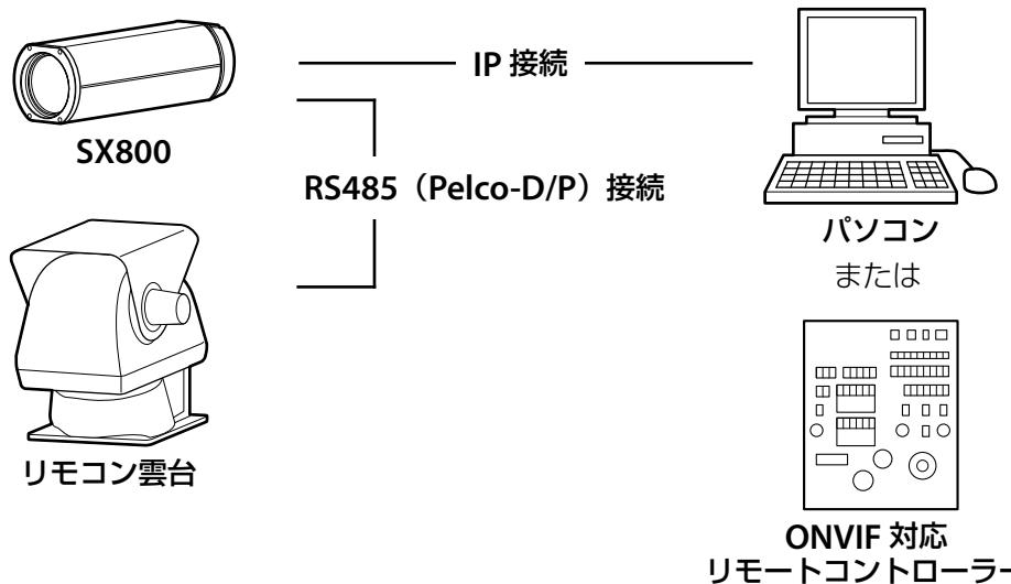
IP モードでカメラとパソコンを接続すると、専用アプリケーションでカメラの環境設定ができます。ONVIF 用アプリケーションソフトでライブ映像の表示、カメラの操作ができます。
