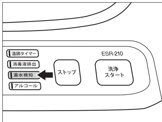
漏水検知用チューブの取り付け確認メッセージ画面が10秒間表示されます。
