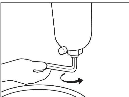
水抜き用ナットがゆるんでいると、水漏れの原因になります。
