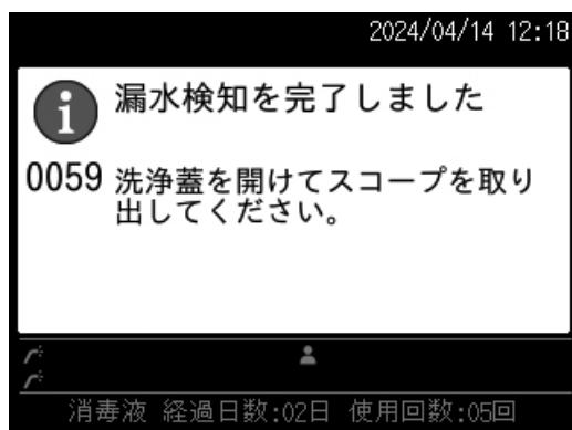
**8** 洗浄蓋を開けて、漏水検知用チューブを外し、内視鏡を取り出します。
