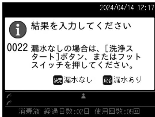
**7** 漏水検知の結果により、[漏水なし] の場合は、[決定] ボタンまたは [洗浄スタート] ボタンを押します。
