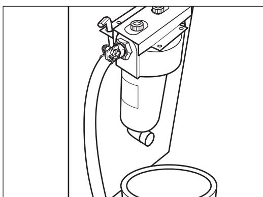
**3** レンチを使って、プレフィルターアハウジング下部の水抜き用ナットを矢印の方向に回して、取り外します。
