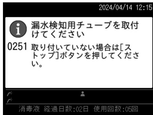
漏水検知用チューブが取り付けられていることを確認してください。
