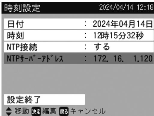
**4** ▲▼ボタンを押して [NTPサーバーアドレス] を選択して、[決定] ボタンを押します。
