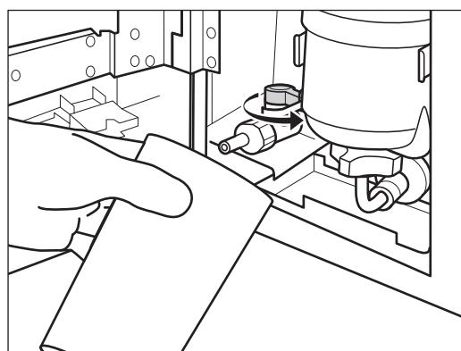
**6** 水フィルターの上部と下部のコネクターを矢印の方向に回して、古い水フィルターを取り外します。
