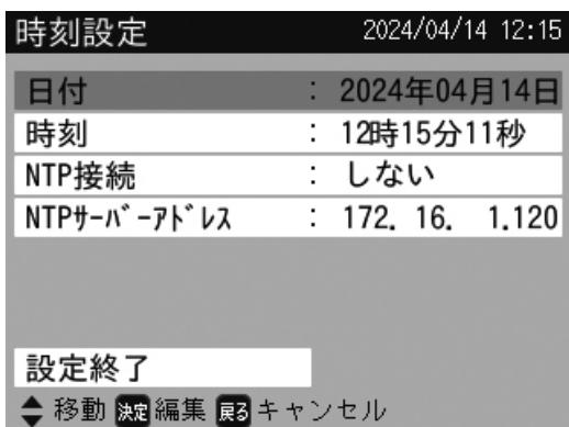
**2** ▲▼ボタンを押して [NTP接続] を選択して、[決定] ボタンを押します。
