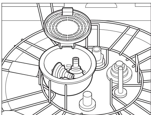
送ガスボタンなど分解できるボタンは分解した状態にして、小物洗浄容器に入れてください。
