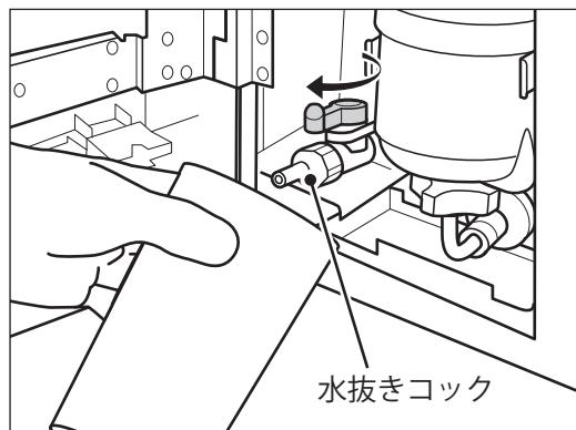
**4** 水フィルター上部にあるつまみを矢印の方向に回して、古い水フィルター内部の水を抜き切ります。
