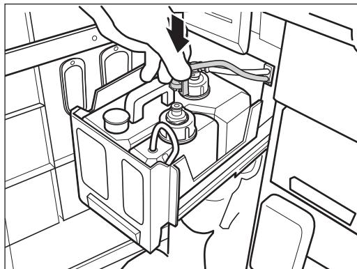
**8** 洗浄液/アルコールトレイを閉めて、前面カバーを閉めます。
