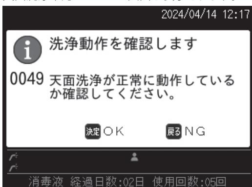
**13** 天面洗浄ノズルから水が出て、天面を洗浄していることを確認して、[決定] ボタンを押します。**13** [ヒント]
