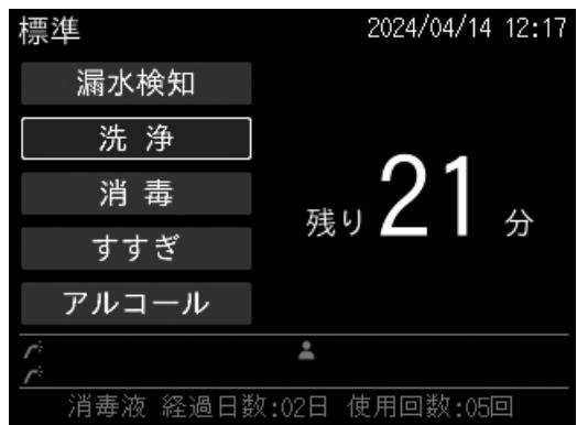
洗浄消毒工程中、内視鏡の挿入部先端から液が出ていることを確認してください。また、給水・循環ノズルや天面洗浄ノズルからの流れを確認してください。確認できない場合は、[ストップ] ボタンを押して洗浄プログラムを中止し、洗浄チューブの接続状態を点検してください。また、[4.2.9 日常点検] を実施してください。
