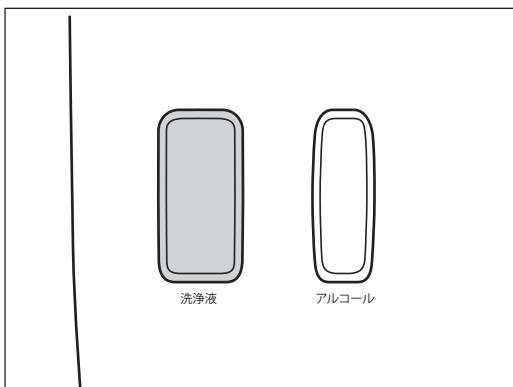
洗浄液の液面が窓から見えなくなる前に、洗浄液を補充してください。
