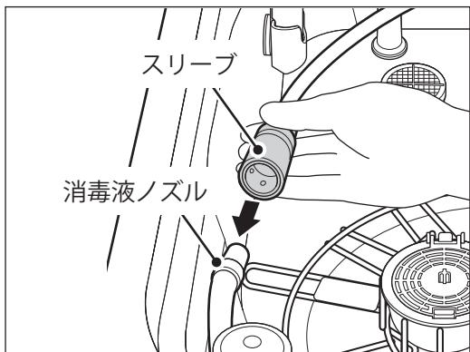
自己消毒ホースの他端を洗浄槽中央部の自己消毒用コネクターに接続します。
