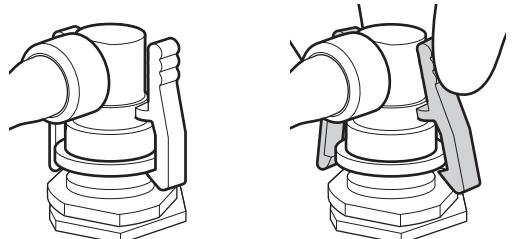
洗浄チューブ（ブルー）、および、予備コネクター用チューブ（グリーン）を洗浄機に取り付けて、装置側コネクターのロックを解除したときの押し戻し力を確認します。
