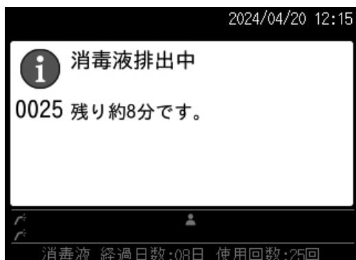
消毒液の排出が終了すると、自動的に洗浄槽のすすぎが開始され、実行中画面が表示されます。
