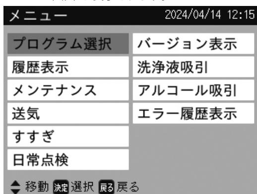
3 ▲▼ボタンを押して「洗浄液吸引」を選択して、[決定]ボタンを押します。
