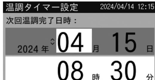
◀▶(左右)ボタンを押してカーソルを移動させながら、▲▼(上下)ボタンを押して数値(月/日/時/分)を変更して、[決定] ボタンを押します。
