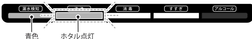
3. 全工程が完了すると、すべてのLEDが青色に点滅して、洗浄プログラムの完了をお知らせします。
