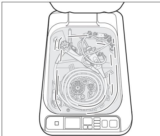
**6** 内視鏡の外表面とすべての管路、および漏水検知チューブの同一箇所から連続的に気泡が出ていないことを確認します。
