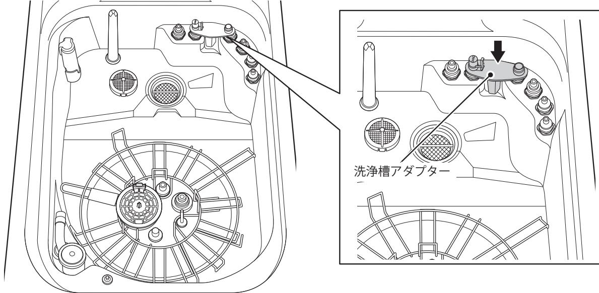
**3** 操作部を洗浄槽奥に、キズなどがつかないように静かに置き、挿入部を保持網の外側から順に時計回りで内側に巻きます。
