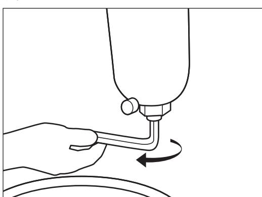
水抜き用ナットを取り外した穴から、排水が始まります。
