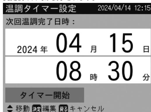
**3** [次回温調完了日時] を確認後、[タイマー開始] を選択して、[決定] ボタンを押します。
