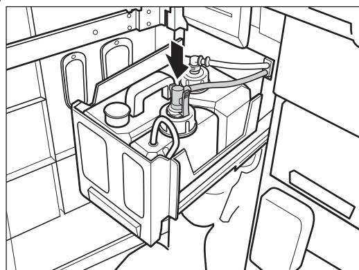
**5** 洗浄液/アルコールトレイを閉めて、前面カバーを閉めます。
