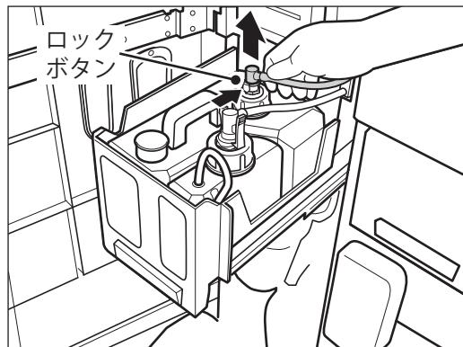
3 洗浄液タンクを装置から取り外して、流し台などに運びます。
