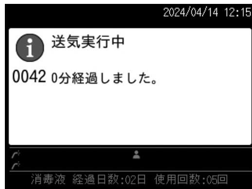
送気実行中画面には、経過時間が表示されます。約3分経過すると、送気は完了して、終了画面が表示されます。
