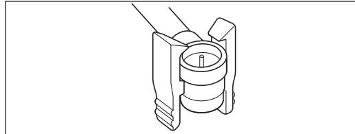
**2** 洗浄チューブの装置側コネクター（ブルー）を洗浄槽内の送気送水／吸引用・鉗子口用コネクター（ブルー）に「カチッ」と音がするまで確実に押し込んでください。
