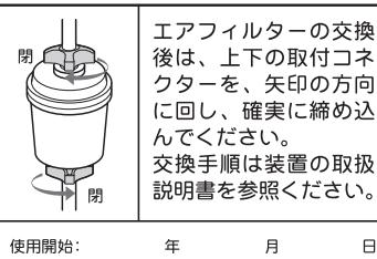
エアフィルターの交換後は、上下の取付コネクターを、矢印の方向に回し、確実に締め込んでください。
