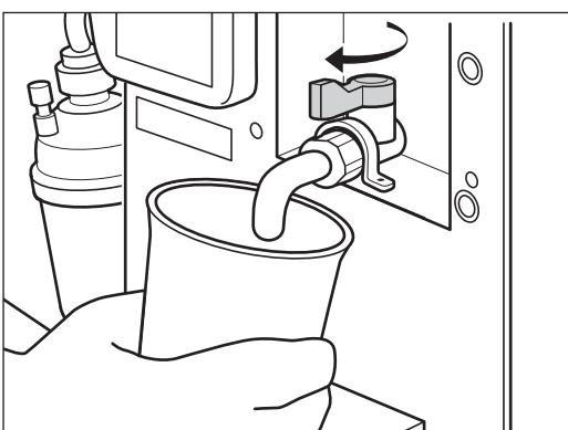
採取後、コックを矢印の方向に回して閉じます。
