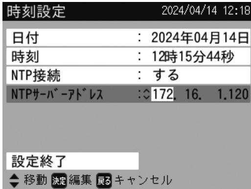
**5** ◀▶ボタンを押して桁を移動し、▲▼ボタンを押しで数値を変更して、[決定] ボタンを押します。
