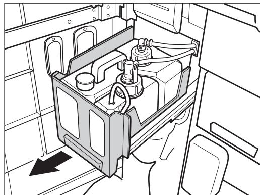
2 洗浄液タンクのキャップにつながれているチューブを保持した状態で、コネクター部分のロックボタンを押してチューブを取り外します。
