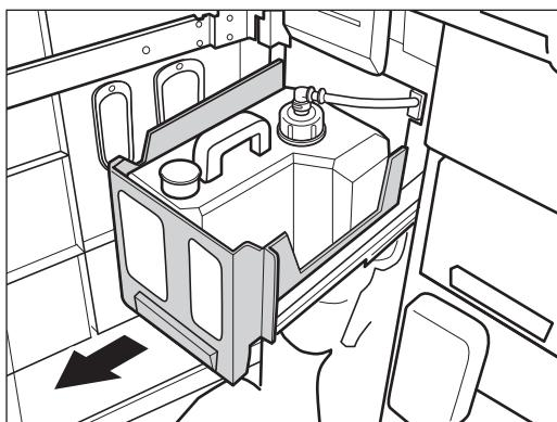
**3** アルコールタンクを洗浄液/アルコールトレイに設置します。
