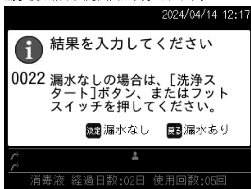
**8** 漏水検知の結果により、[漏水なし] の場合は、[決定] ボタンまたは [洗浄スタート] ボタンを押します。[漏水あり] の場合は、[戻る] ボタンを押します。
