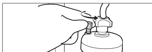
**5** 水の排出が終わったら、コックを矢印の方向に回して閉めます。
