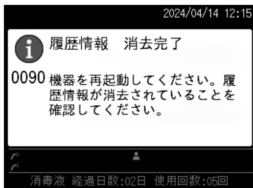
**6** 電源をOFF/ONにして装置を再起動します。
