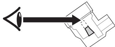
**4 洗浄機に取り付けて洗浄チューブの装置側コネクター内部のピンが破損していないかを確認します。**
