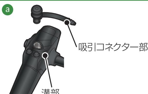
a 吸引シリンダーの溝部と吸引ボタンの吸引コネクター部の向きを合わせます。
