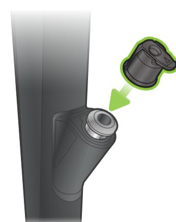
鉗子栓に損傷がないことを確認し、取り付けます。
