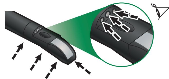
先端部、わん曲部（両端の樹脂含む）に損傷や異物がないことを確認します。
