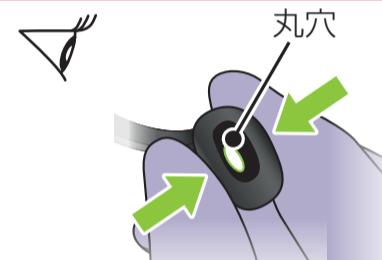
スリットと丸穴に損傷がないことを確認します。
