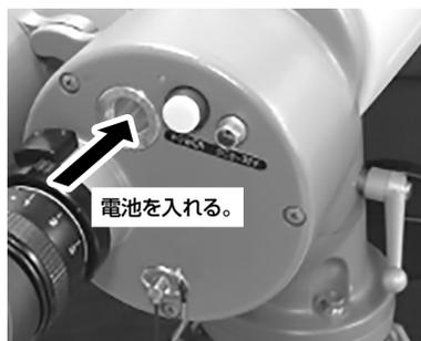
3 電池が正しく入ったら、電池ケースキャップを時計方向にしっかりとねじ込みます。
