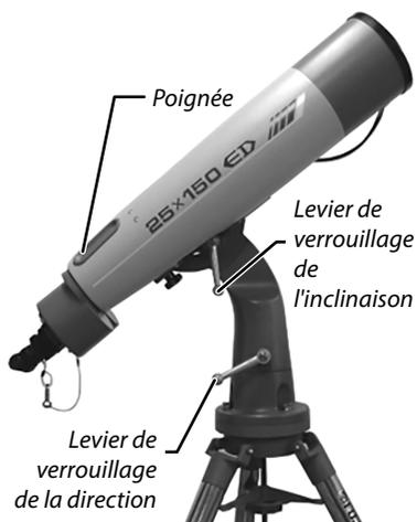
**À propos du levier de verrouillage** Vous pouvez changer la position de rotation du levier de verrouillage de l'inclinaison et du levier de verrouillage de la direction en tirant le levier vers l'extérieur et en le tournant vers la position souhaitée.
