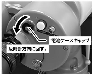
2 リチウム電池（CR123A 型）の+、-方向を確認して入れます。
