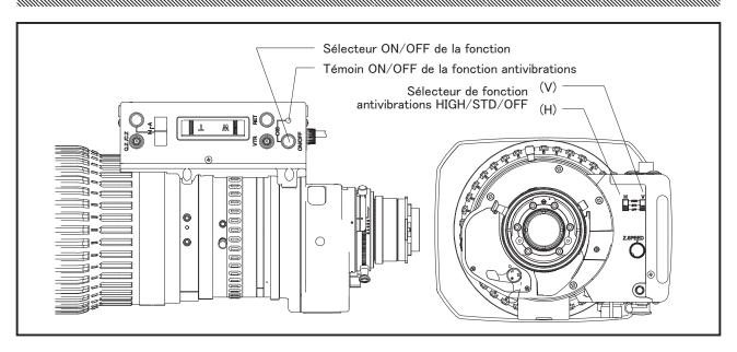
L'utilisation de la fonction antivibrations permet d'obtenir une image stable en tout temps, car elle réduit le flou de bougé causé par le vent lors des événements sportifs en direct à l'extérieur, par un équilibre instable au sol, etc.
